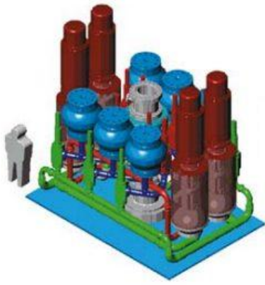
Рис.Х Подводный модуль подъема бурового раствора (габаритные размеры)
