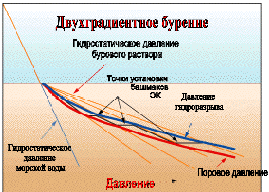
Рис.Х Потребность в обсадных колоннах для двухградиентного бурения
